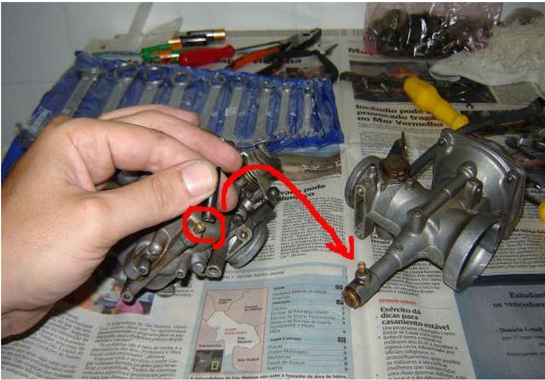
Abb. 22. Kurzen Verbindungsschlauch zwischen Schwimmerkammer und Sekundärvergaser abziehen und gut wegpacken.
