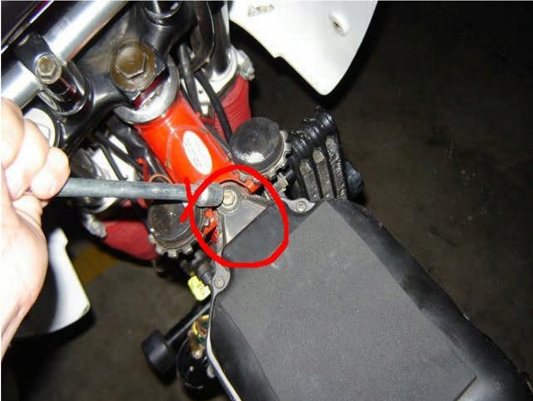
Abb. 1. Schraube entfernen die den Luftfilterkasten hält (Schlüsselweite 10 mm)Abb
