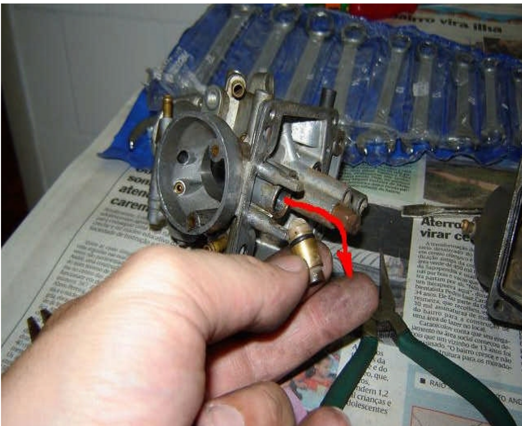
Abb. 37. Auf dem Schwimmerventilsitz sieht man das Filtersieb.
