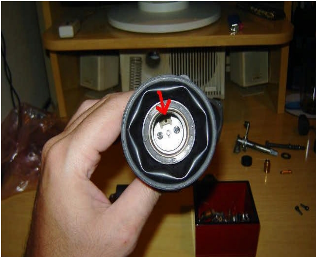
Abb. 52. Blick in den Schieber: die Nadelhalterung.
