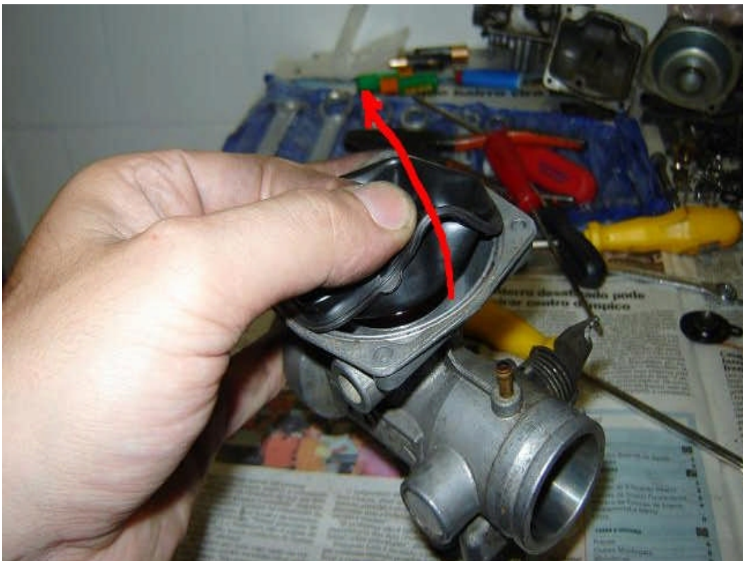
Abb. 51. Die Membran kann einfach aus ihrer Nut gezogen werden. Man beachte, dass es für das Ohr am Rand eine Vertiefung im Vergaser gibt.
