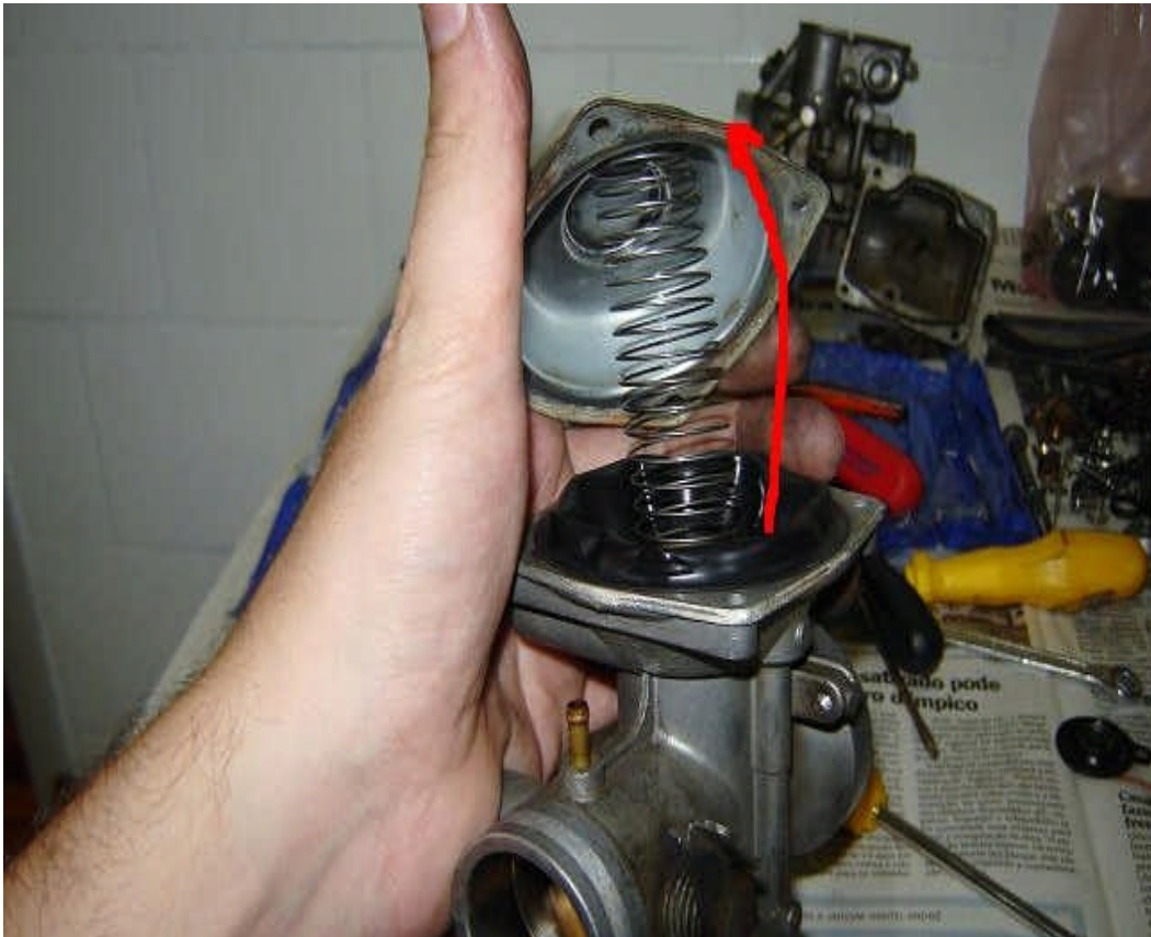
Abb. 50. Beim Deckel abnehmen auf die Feder und die Membran achten.
