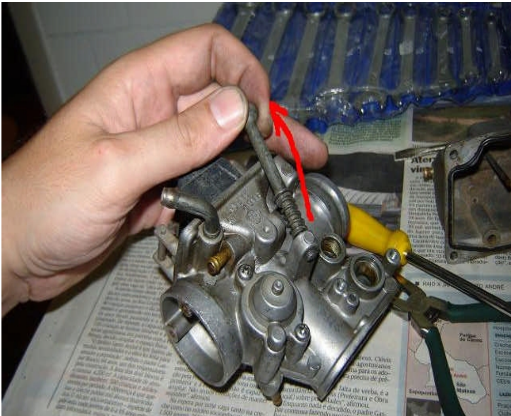
Abb. 32. Einstellschraube für die Leerlaufdrehzahl entfernen. Gewinde gründlich entfetten mit Drahtbürste reinigen, später beim Zusammenbau fetten nicht vergessen.
