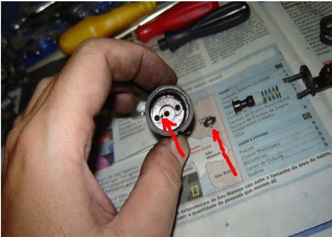
Abb. 48. Dieses Loch muss beim Zusammenbau später in Deckung sein mit der Nase in der Scheibe.
