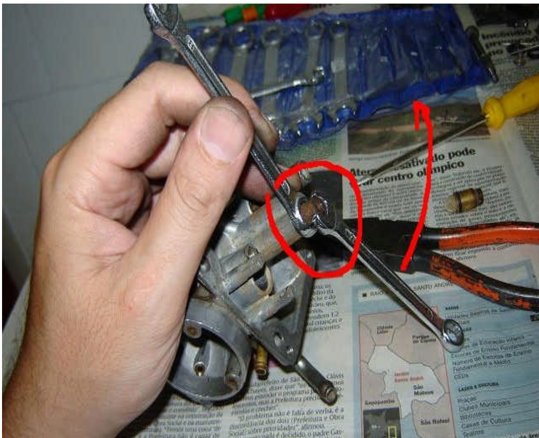
Abb. 39. Mit zwei Ringschlüsseln die Hauptdüse aus der Nadeldüse schrauben, dann die Nadeldüse herausrauben.
