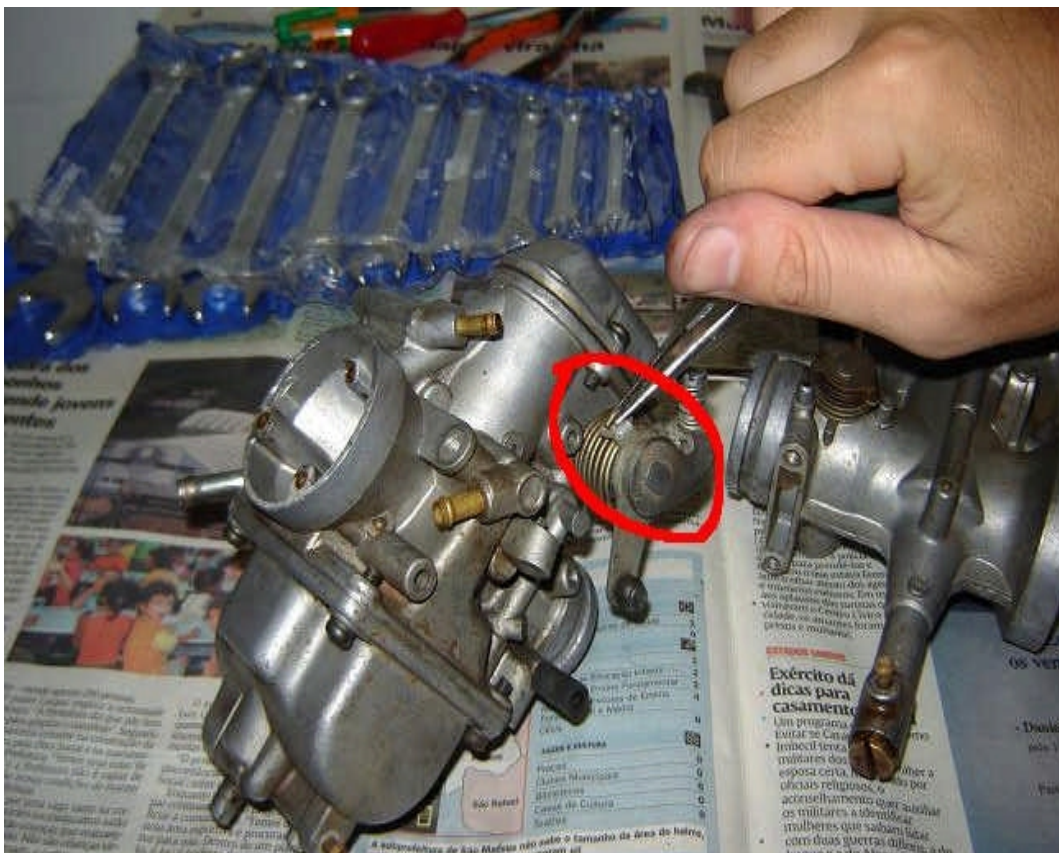
Abb. 23. Mit Spitzzange die Feder am Primärvergaser entspannen (aushängen).
