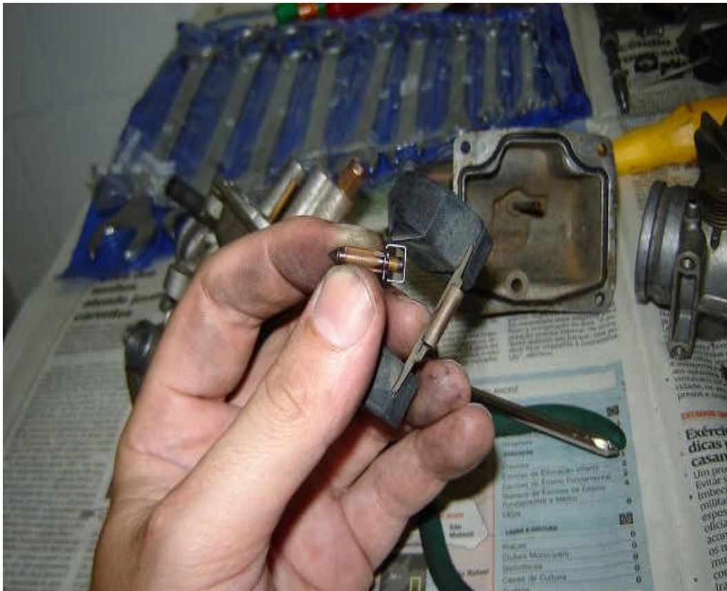
Abb. 34. Schwimmer samt Schwimmerventil entnehmen, ersetzen wenn verschlissen. Originalteil 1JK-14107-01-00 Preis US$33.00
