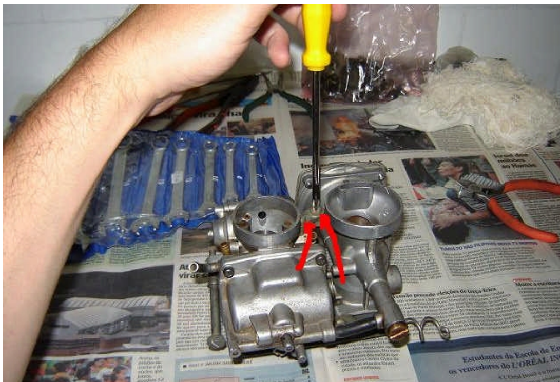
Abb. 19. Brücke zwischen linkem Primär- und rechtem Sekundärvergaser entfernen
