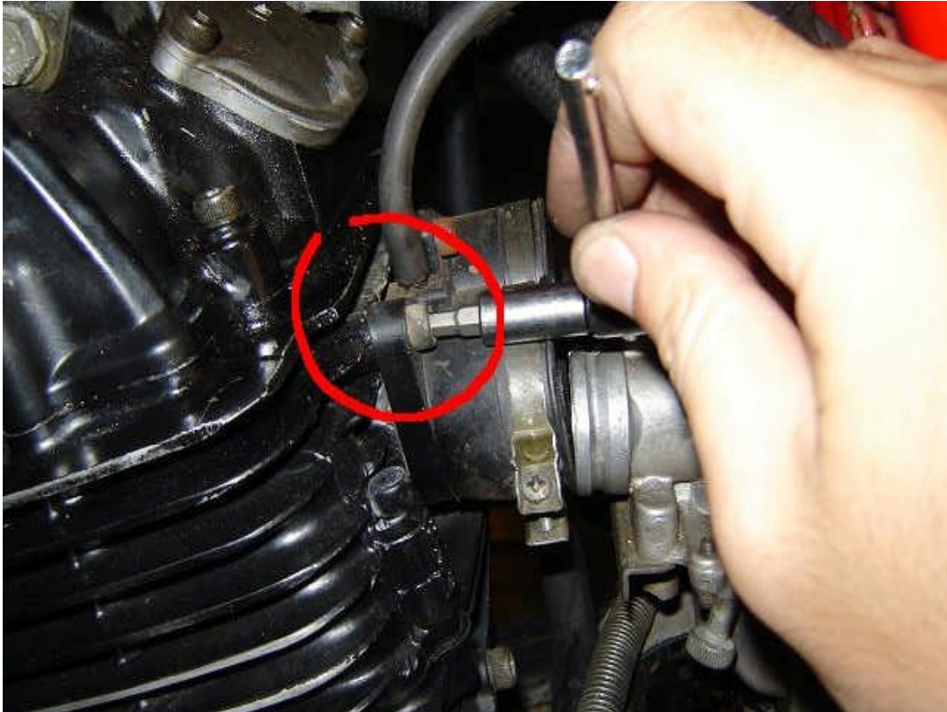
Abb. 15. Bei abgezogenem Vergaser entfernt man am besten den linken Ansaugstutzen, um den Ausbau des Vergasers zu erleichtern. Mit der oberen Schraube beginnen: entfernen.
