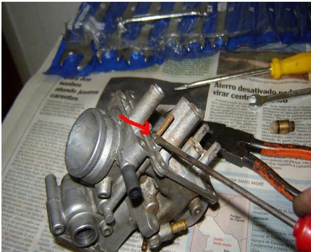
Abb. 41. Diesen O-Ring vorsichtig entfernen und gut verwahren (5Y1-14536-00-00)
