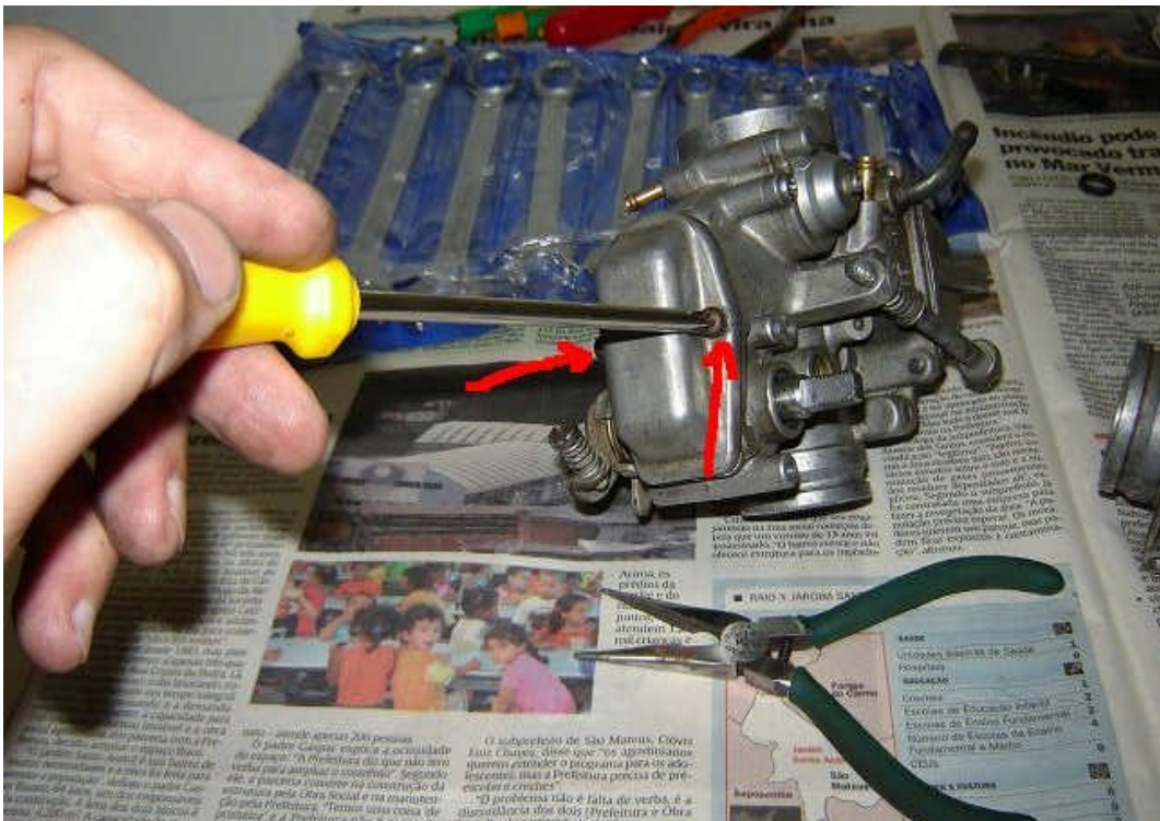
Abb. 25. Schrauben am Deckel des Primärvergaser lösen.
