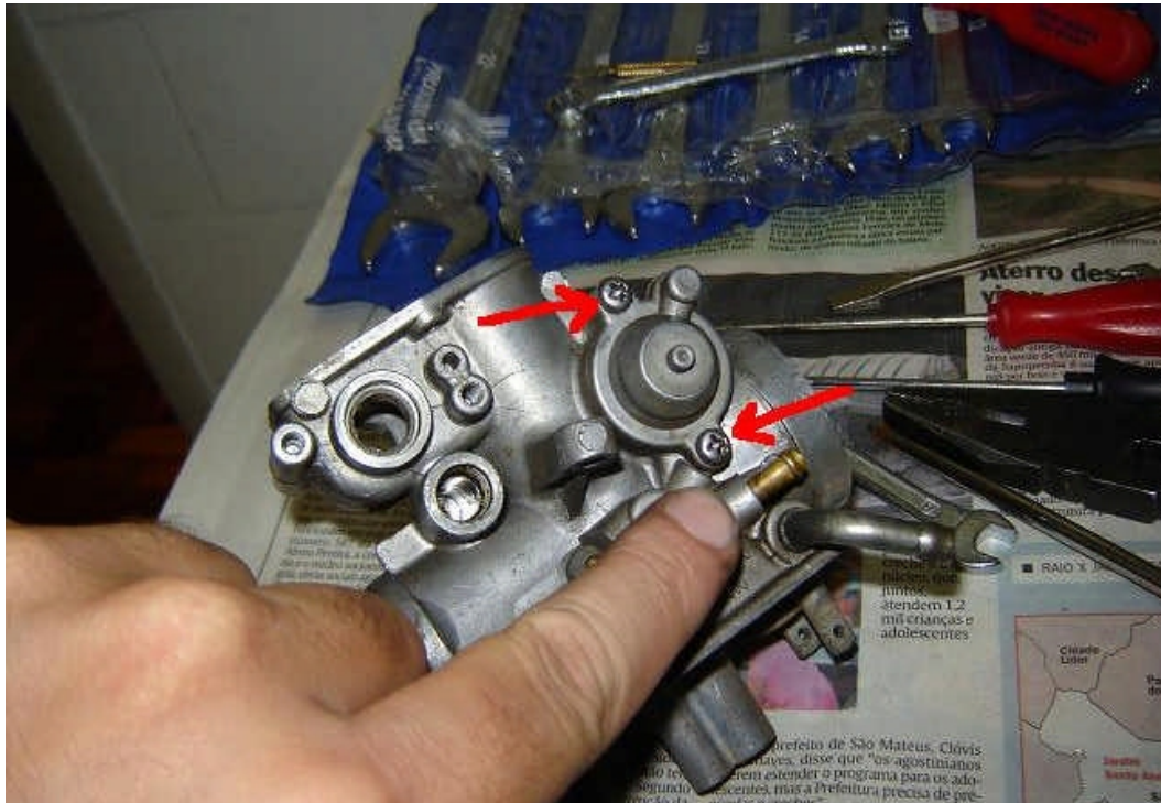
Abb. 44. Deckel der Schubanreicherung abnehmen, das Membranventil macht das Gemisch im Schiebebetrieb fetter (gegen Auspuffpatschen).
