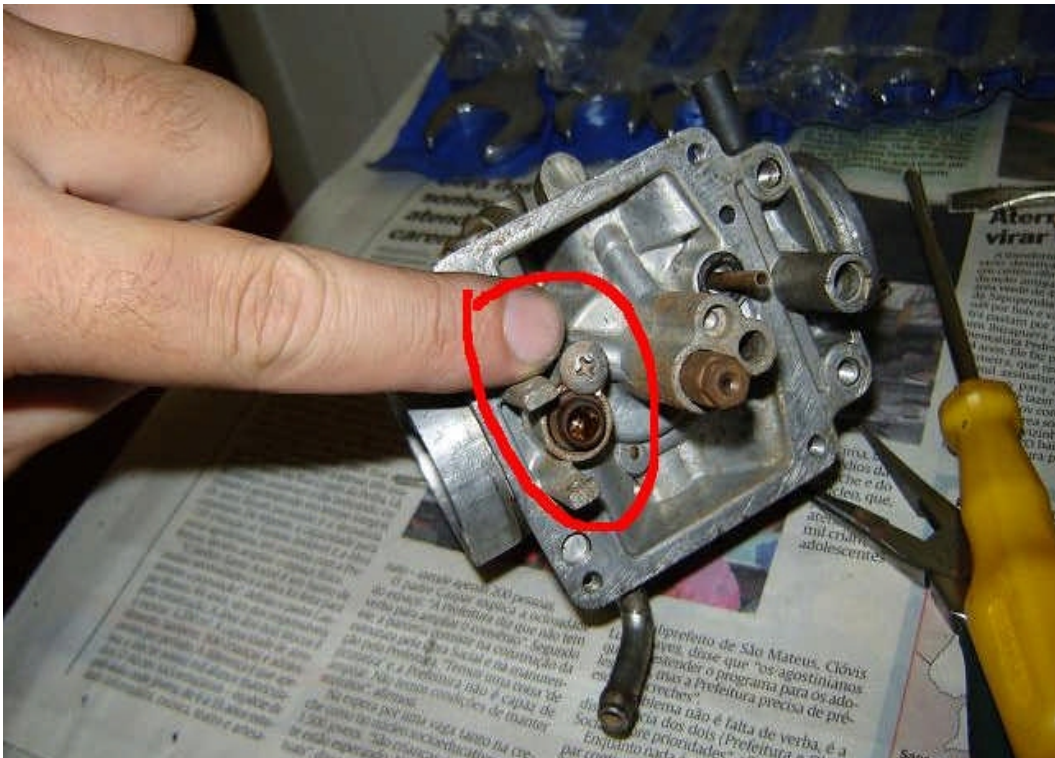
Abb. 35. Halteschraube des Schwimmerventilsitzes lösen.
