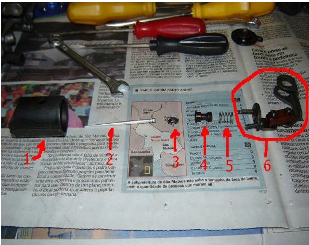
Abb. 47. Schieber (1) Nadel (2) Scheibe (3) Plastikverbinder (4) Feder (5) Zugverbinder Set (6)
