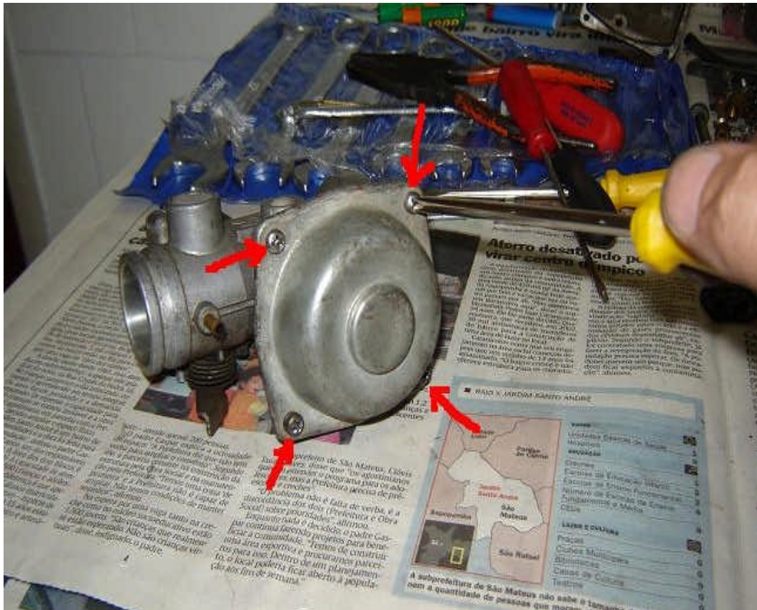
Abb. 49. Die vier Schrauben des Membrandeckels entfernen und Deckel abnehmen. Vorsicht: unterhalb ist eine große Feder. Schrauben ersetzen wie Schwimmerkammer.
