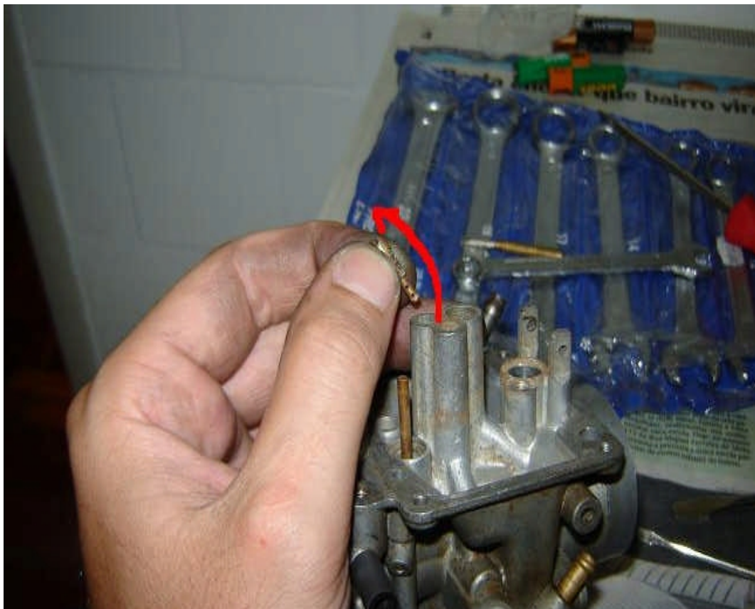
Abb. 43. Leerlaufdüse gründlich reinigen. Sehr kleine Bohrung, wächst gerne zu.
