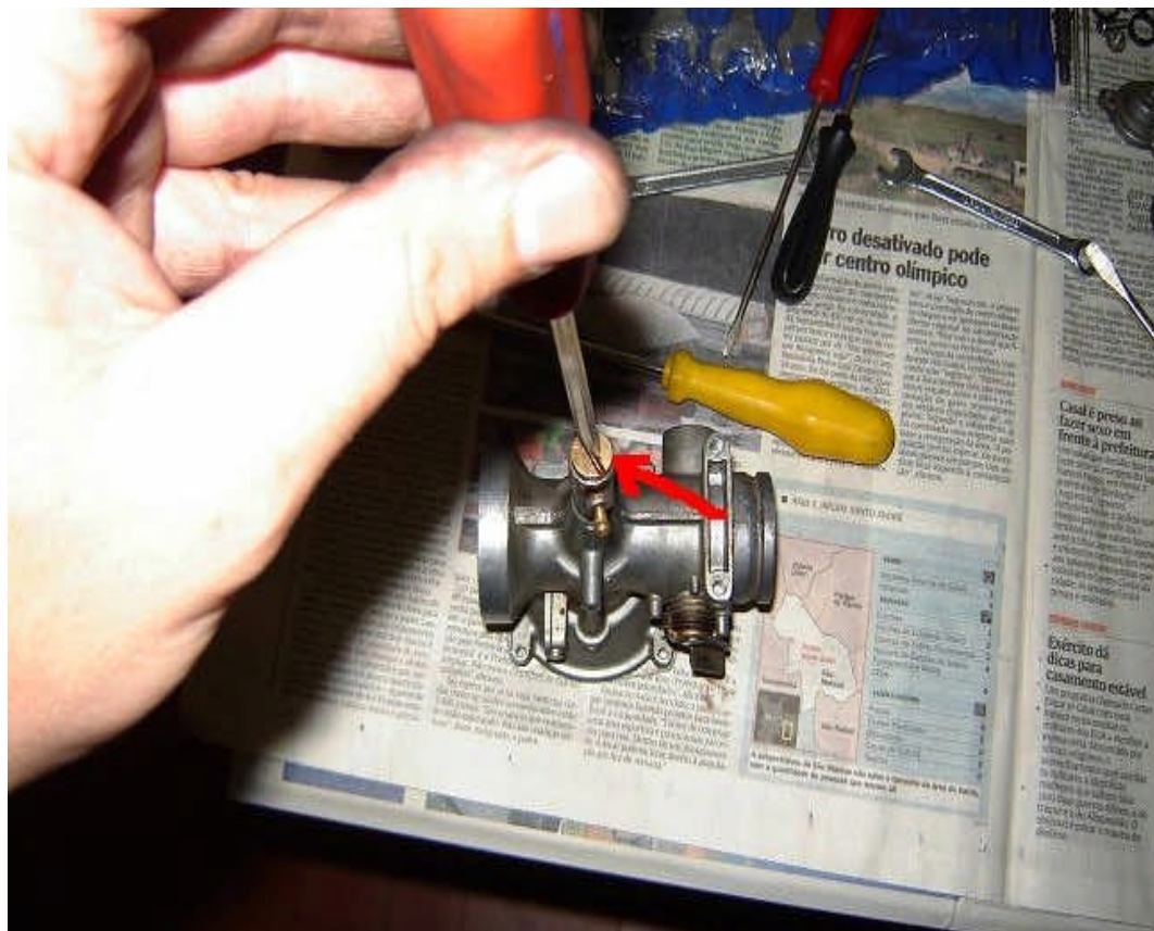
Abb. 55. Schraube öffnen: Zugang zu Hauptdüse (5Y1-14343-63-00), Nadeldüse (5Y1-14355-00-00)
