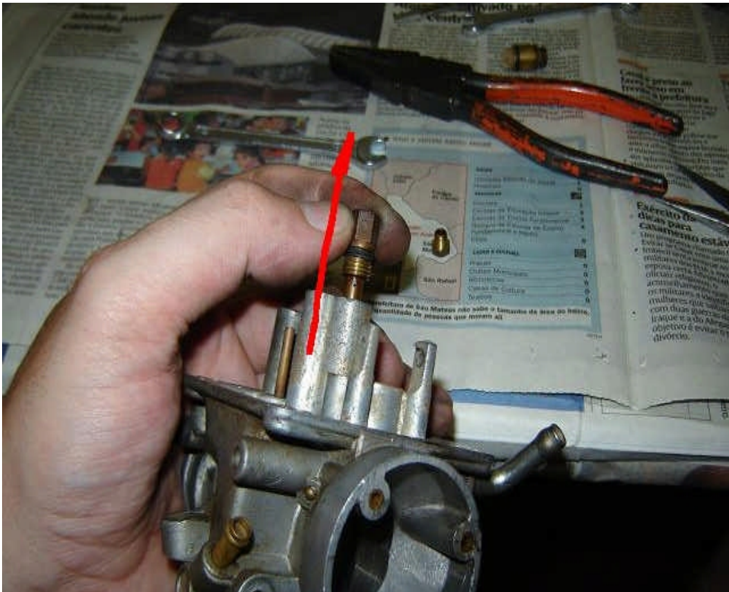
Abb. 40. Nadeldüse prüfen und gründlich mit Pressluft reinigen, auch die feinen seitlichen Bohrungen! Ersatzteile: (43F-14341-00-00) (360-24512-00-00) (288-14343-65-00)
