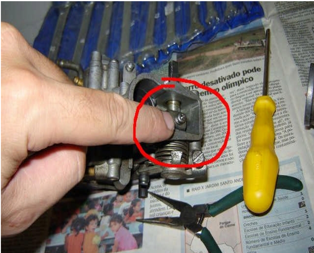
Abb. 26. Nach Entfernung des Deckels diese Schraube entfernen, um die Nocke abziehen zu können.
