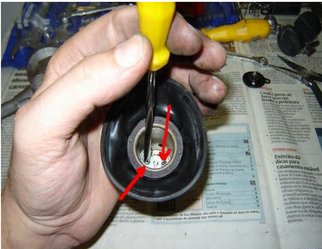
Abb. 53. Zwei Schrauben entfernen, die die Nadel-Halteplatte im Schieber befestigen.
