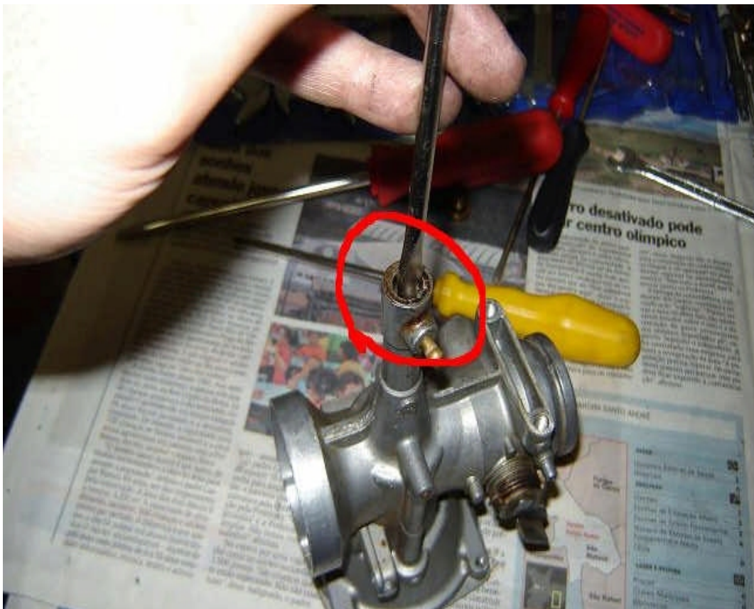
Abb. 57. Hauptdüse mit PASSENDEM Schraubendreher herausschrauben.
