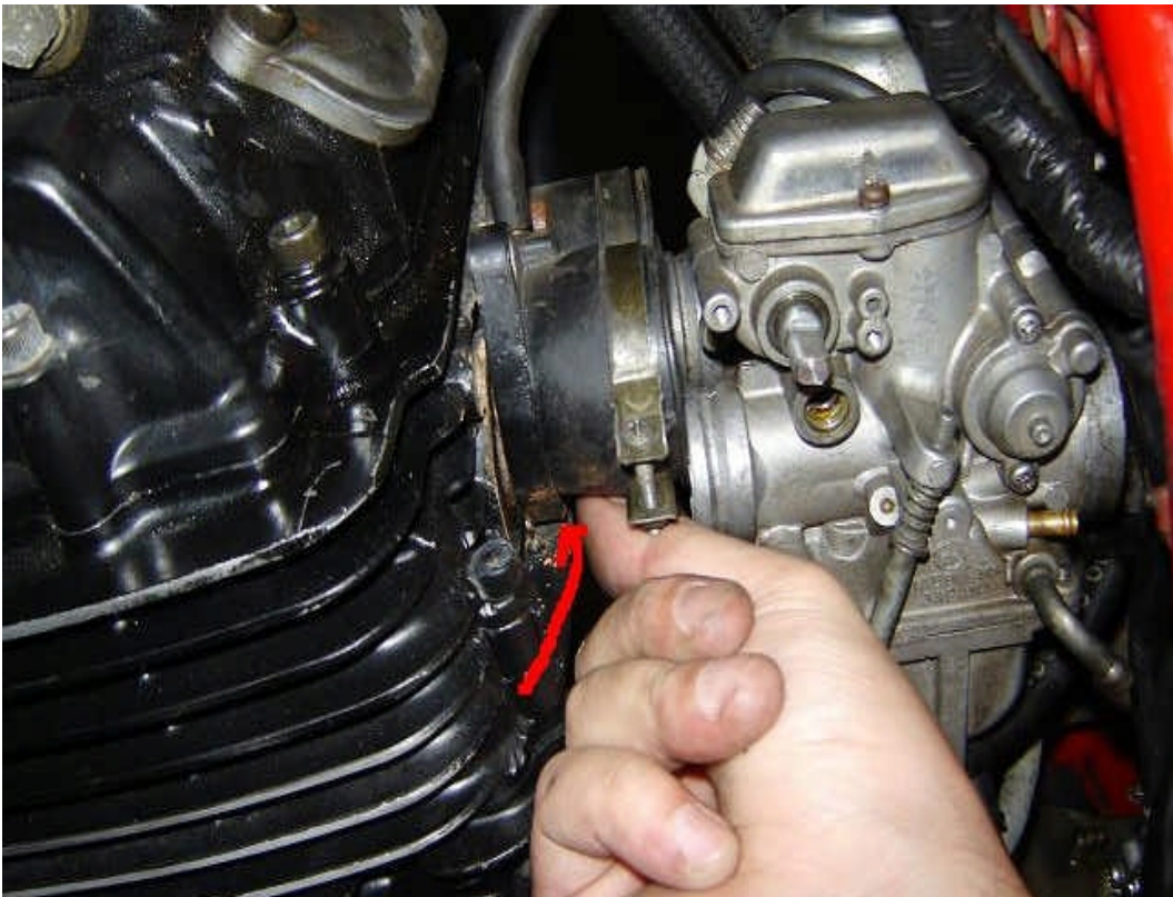
Abb. 16. Dann kann man den Stutzen leicht drehen um besser Zugang zur unteren Schraube zu kriegen. Nach Entfernung der unteren Schraube den Stutzen entfernen, dabei den O-Ring nicht verlieren.
