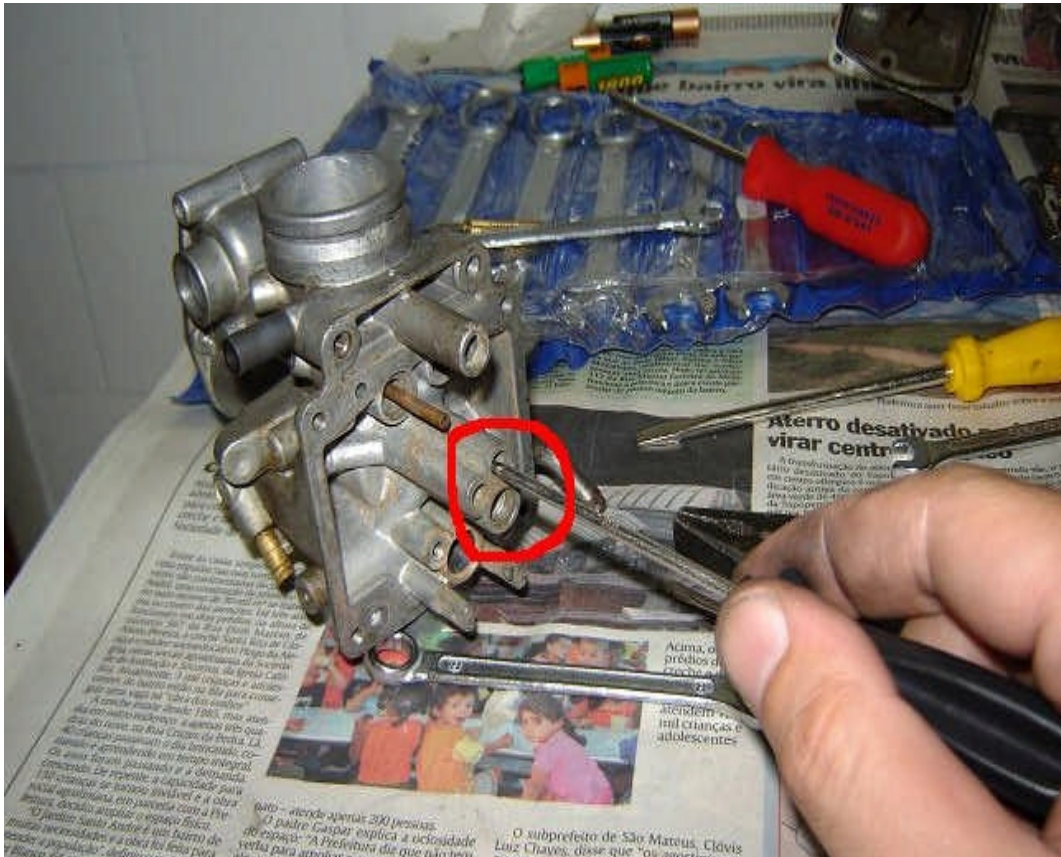
Abb 42. Leerlaufdüse: passenden Schlitzschraubendreher verwenden! (43F-14342-23-00)
