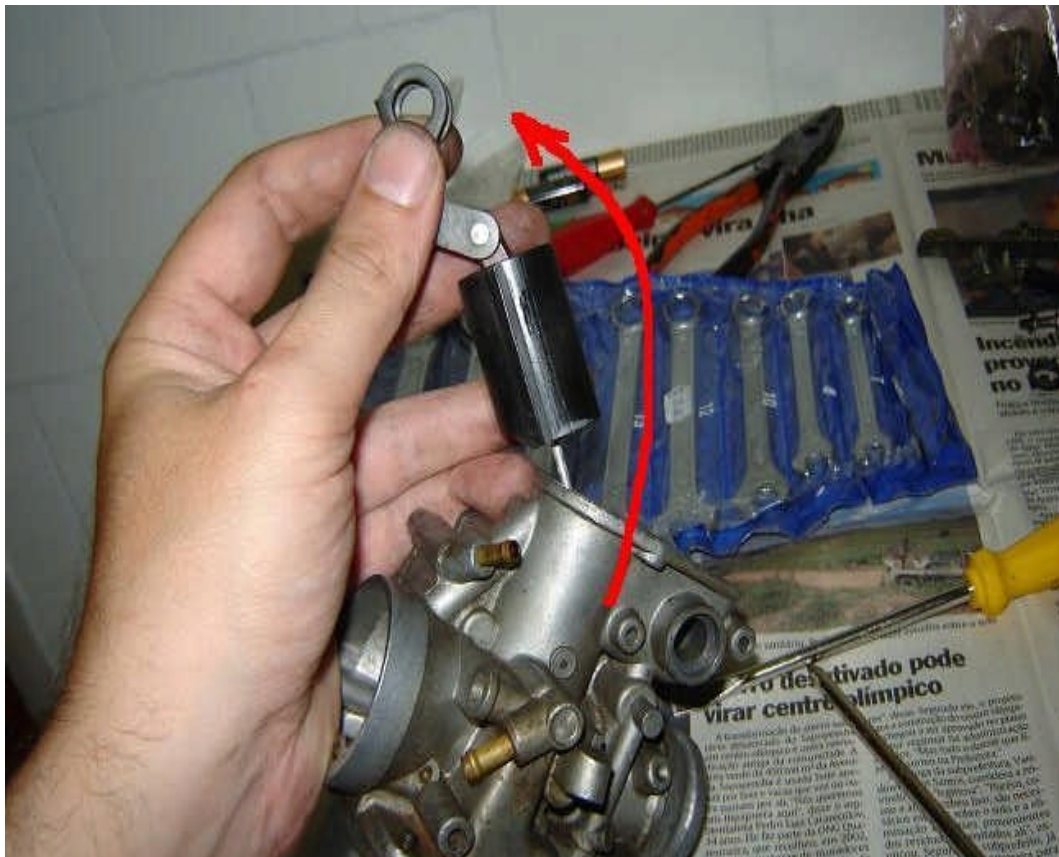
Abb. 29. Schieber vorsichtig herausziehen, dabei die Nadel nicht verbiegen.
