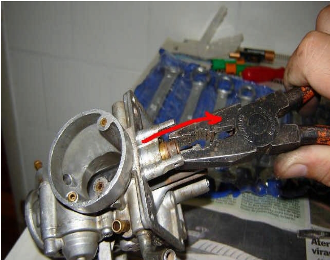
Abb. 36. Schwimmerventilsitz vorsichtig entfernen, kann recht fest sitzen, aber man will zum Filtersieb dahinter gelangen um es zu reinigen.
