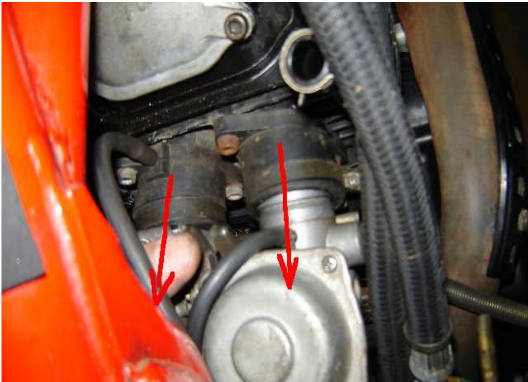
Abb. 14. Vergaser vorsichtig nach hinten ziehen, dabei etwas rauf und runter bewegen, nicht herumreißen sonst kann man sie ruinieren. Warmer Gummi ist weicher ...
