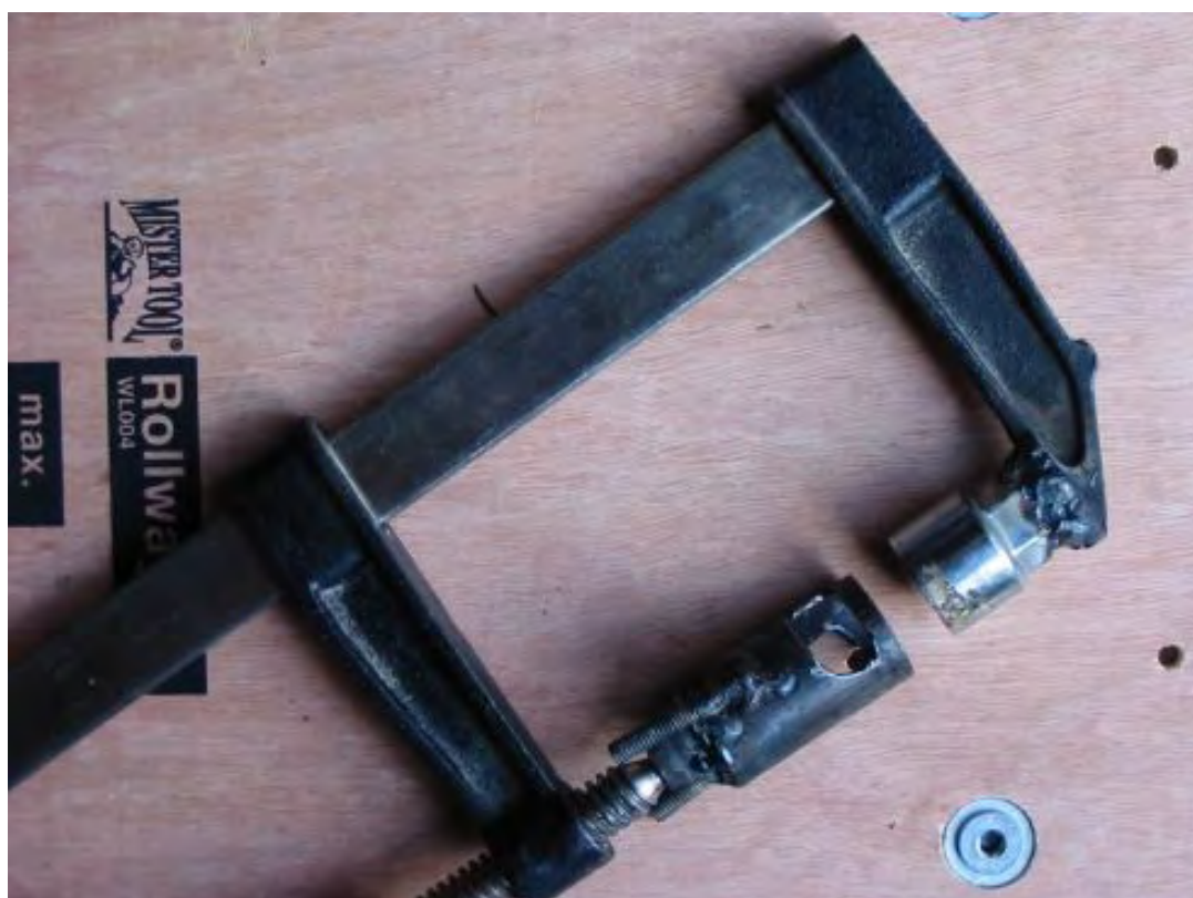
Die Ventilzwinde sorgt für stressfreien Aus- und Einbau.
