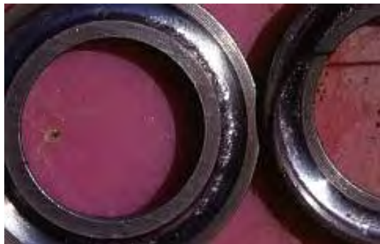
Zum Wegschmeißen oder Lager eintreiben: kaputte Schrägkugellager-Schalen
