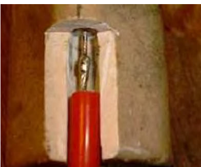
Beim Aufsägen bitte den Pin dranlassen
