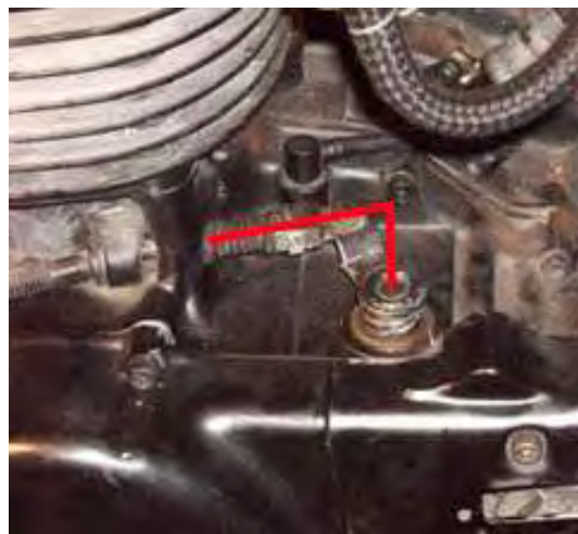
Winkelsache - sollte 90 Grad betragen wenn die Kupplung im unbelasteten Zustand.
