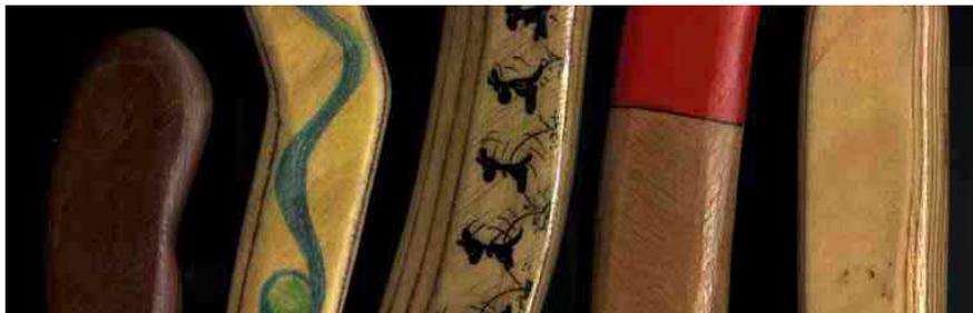
Abb. 18: Sperrhölzer von links nach rechts: Bootsbauspertholz Buche, Birke 4mm 3schichtig, Pappel, Möbelbauspertholz Buche, Flugzeugsperrholz Birke.
